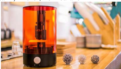
Рис 1. SLA-принтер та вироби
