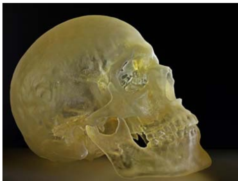
Рис 5. Череп людини виготовлений за SLA-технологією
