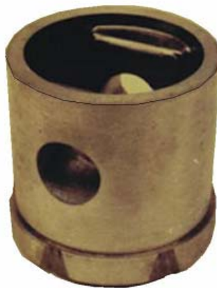
Рисунок 4 – Композитний поршень для двигуна внутрішнього згоряння
