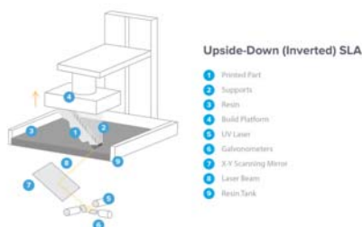
Рис 3. SLA-принтер інвертованого типу
